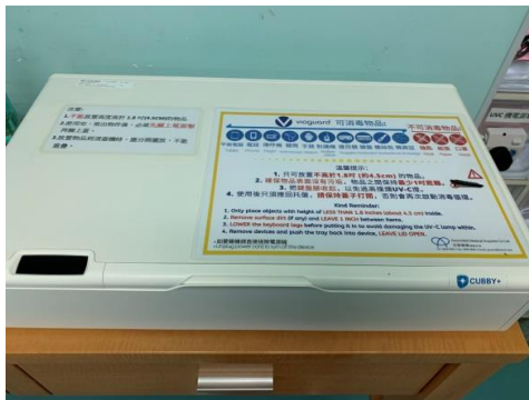
每一樓層均擺放一部紫外線消毒機，方便前線人員消毒日常工具
